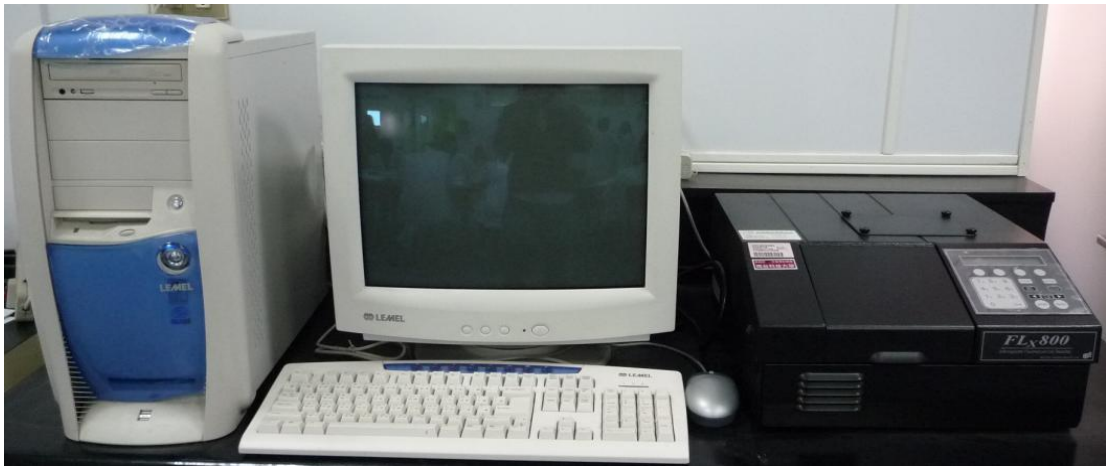
Figure 12. 可見光紫外光吸收光譜儀
