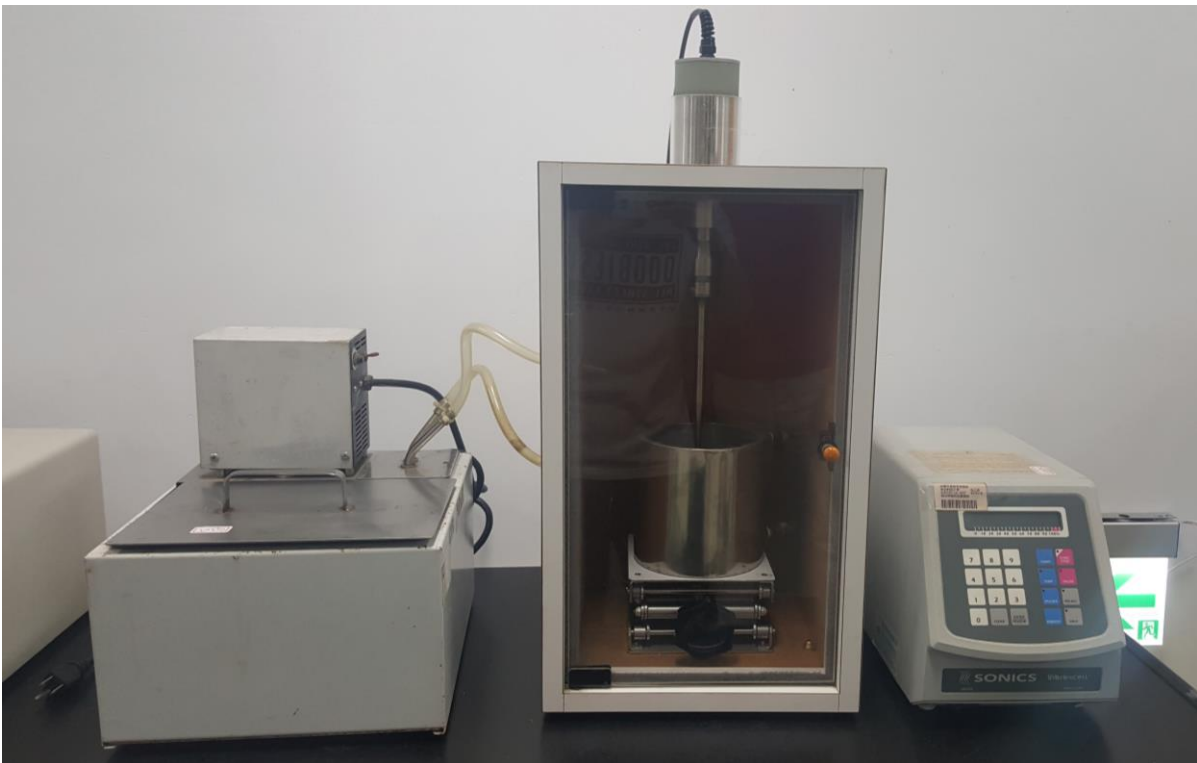
Figure 17. 超音波細胞粉碎均質機(Vortex)
